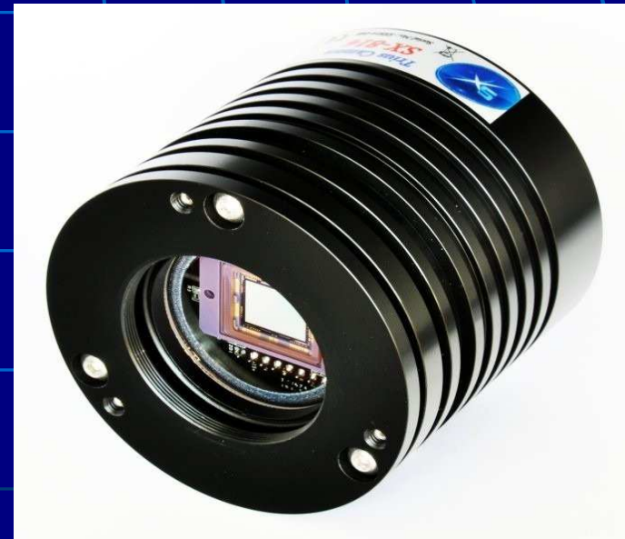
Camera CCD dotata di sensore monocromatico, caratterizzato da una elevata efficienza quantica e un rumore termico estremamente basso.
