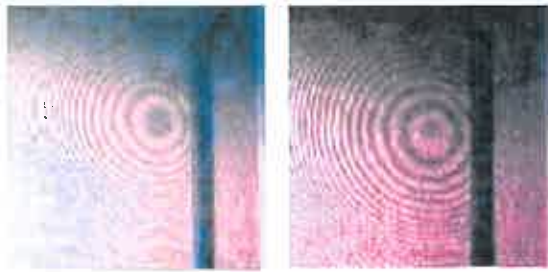
Fig. 4 Modello di interferenza di due onde circolari, se gli assi dei raggi sono sovrapposti o formano un angolo piccolo
