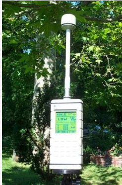
Lo strumento 8053 posizionato sul treppiede dielettrico.
