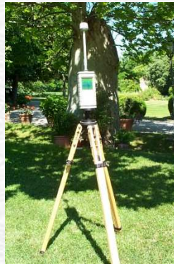
Lo strumento 8053 posizionato sul treppiede dielettrico.
